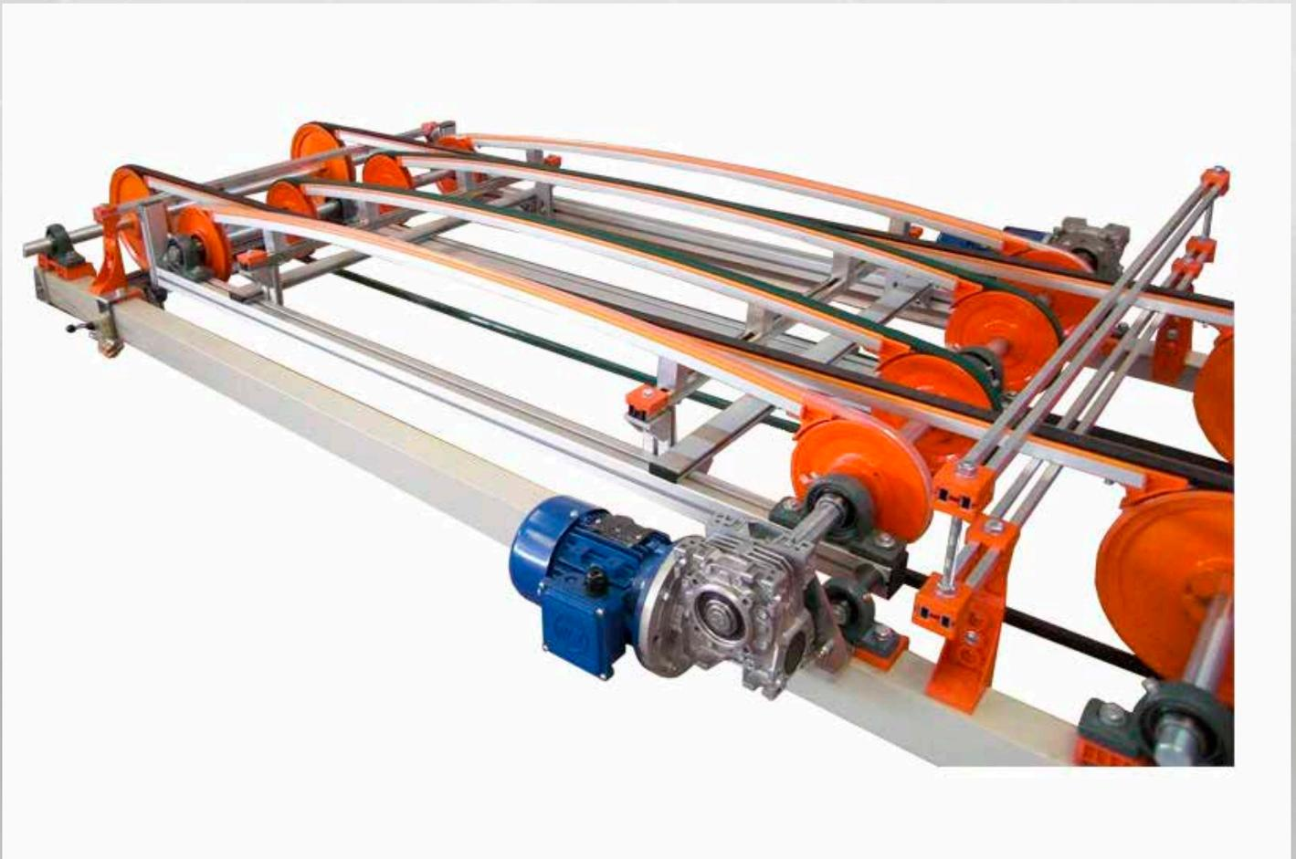
**Macchina usata per ruotare le piastrelle di novanta gradi
